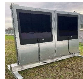
ペロブスカイト太陽電池付き防音壁（試作品）
